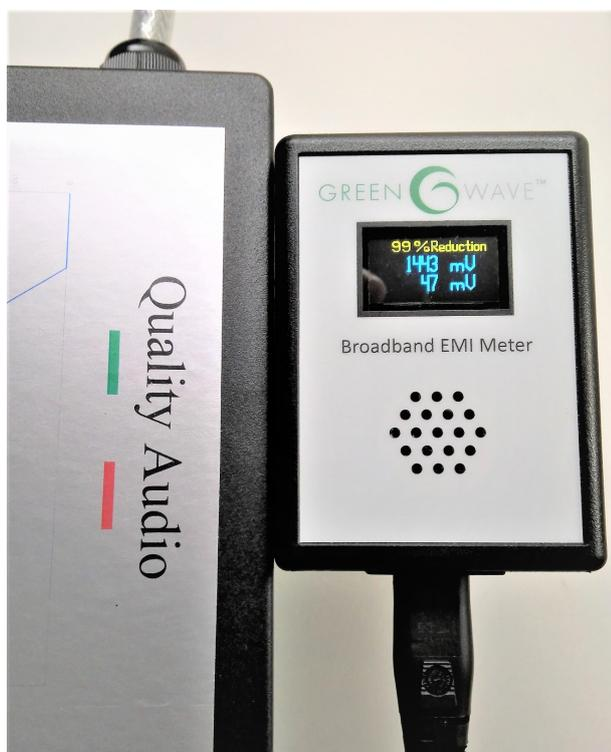
Grazie al Misuratore EMI Meter della Green Wave, visibile nella foto a lato, è possibile leggere direttamente la diminuzione delle Spurie EMI in millivolts.
