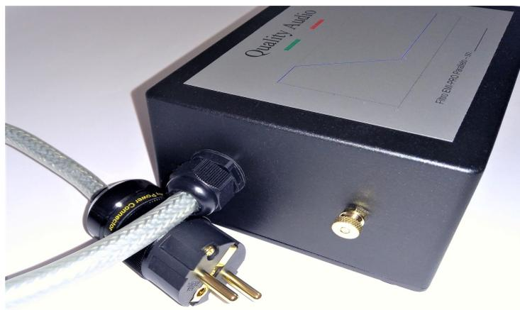
Nella foto sopra è possibile notare il pomellino a ghiera che potrebbe tornare utile per collegare un cavetto di massa, ad esempio quello del giradischi o del preamplificatore Phono.
